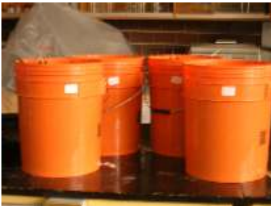
Figura 4. Material para la construcción de ocho reactores (recipientes de plástico), de 36 cm de altura y 28.5 cm de diámetro (volumen total = 0.023 \text{ m}^3 y volumen útil = 0.0191 \text{ m}^3 ), con una pendiente mínima ( 3^\circ ) soportados en una tabla de madera y cada uno con una tubería de salida para recolectar los lixiviados
