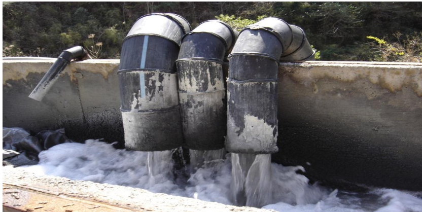
Figura 1a. Agua de reproceso bombeada de la presa de jales hacia la nave industrial donde se realiza la flotación para enriquecer los minerales deseables (esfalerita, galena y calcopirita) (Pacheco Gutiérrez y Durán de Bazúa, 2006)
