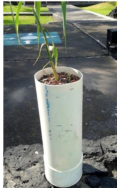
**Figura 3b.** Reactor de PVC para el crecimiento de las plantas acuáticas
