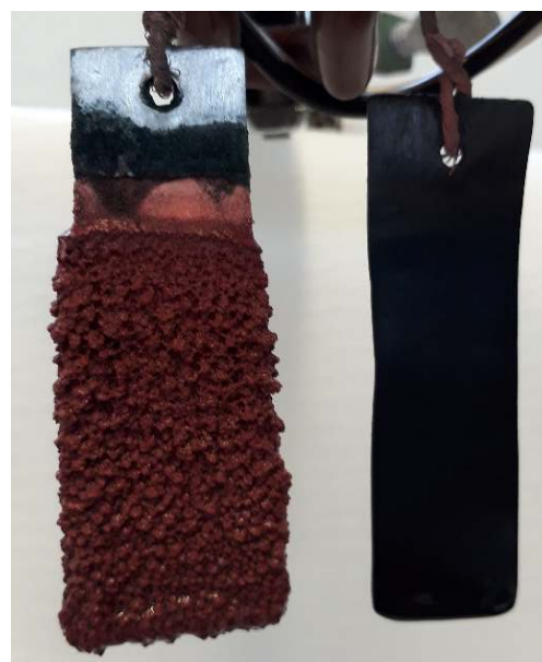
Figura 14b. Electrodo de acero inoxidable 316 L (izquierda) y electrodo de plomo (derecha), después de la electrodeposición
