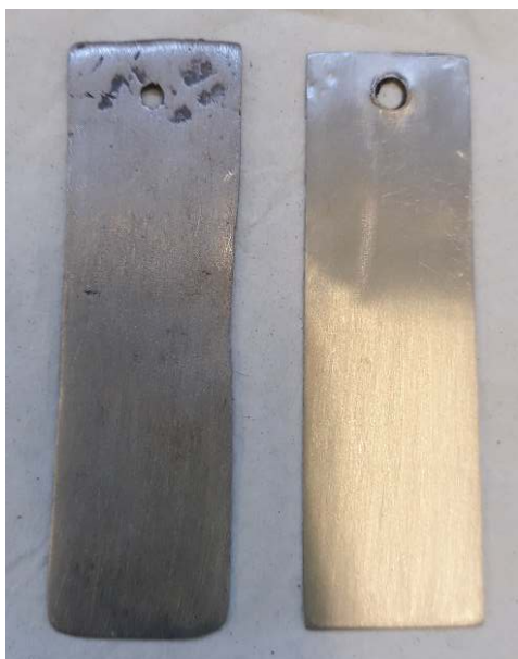
Figura 14a. Electrodo de acero inoxidable 316 L (derecha) y electrodo de plomo (izquierda), antes de la electrodeposición
