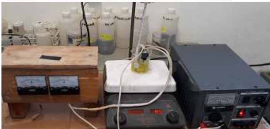
Figura 13. Sistema para la electrodeposición empleando una fuente de poder (Steren PRL-25 y medidores de corriente y voltaje)
