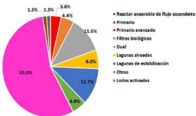
**Figura 1.** Principales sistemas de tratamiento de aguas residuales usados en México (Conagua, 2016, tomado de Vidal-Álvarez, 2018)
