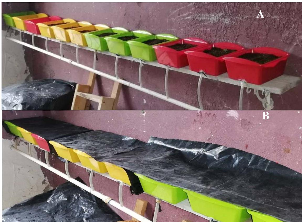
**Figura 1.** Biorreactores de los distintos tratamientos realizados durante el experimento, se observa tubería que permite el drenado de los lixiviados (A). Biorreactores cubiertos con plástico para mantener la humedad y temperatura estable (B)
