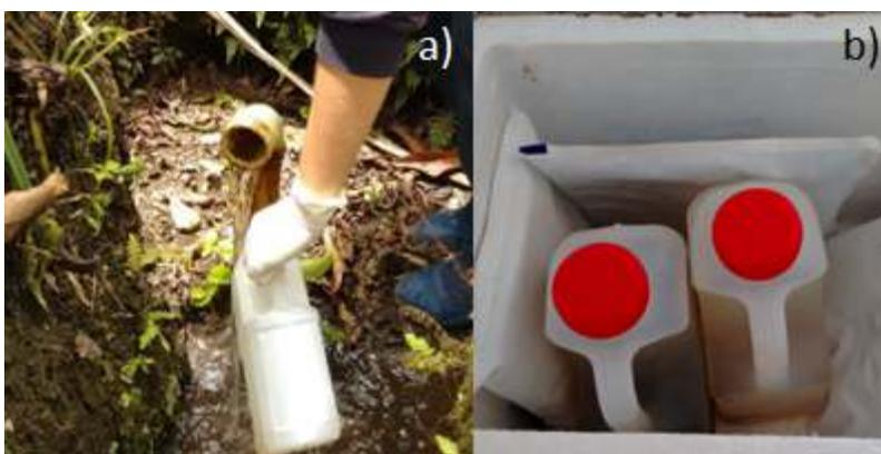
**Figura 3.** Método de muestreo: a) Toma de muestra de aguas residuales. b) Transporte de muestras
