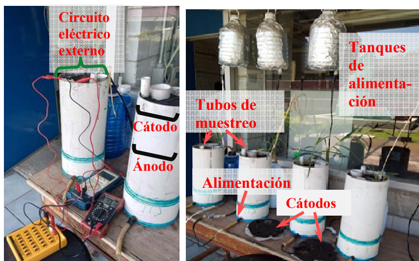
Figura A. Diagrama esquemático del sistema de biorreactores empacados que simulan humedales artificiales asistidos electroquímicamente
