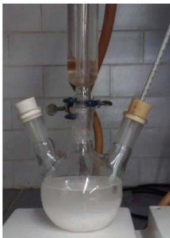
Figura 1. Equipo de reflujo para la elaboración del disolvente MAC-141©
