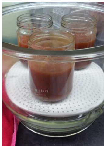
Figura 2. Almacenamiento de la mezcla Q-Qn en una cámara de humidificación
