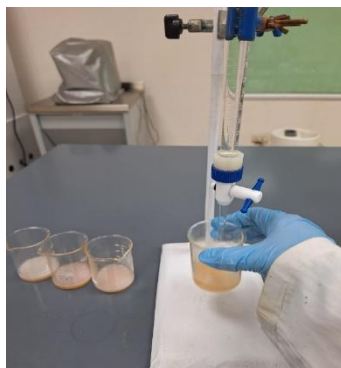
Figura 2. Determinación del índice de acidez del aceite
