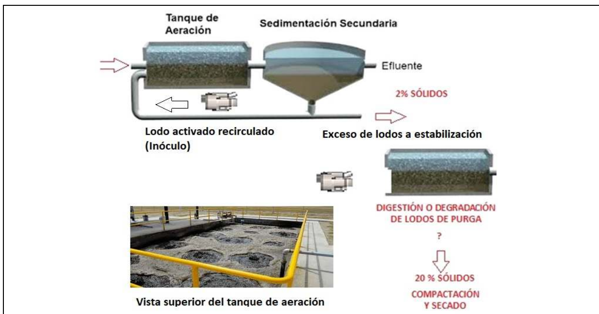
Figura 1. Detalle de una planta de lodos activados (fotografía y diagramas propios) donde una parte de la biomasa microbiana producida se recicla como nuevo inóculo y el excedente debe enviarse a estabilización y reducción de volumen y masa para cumplir con la norma correspondiente (DOF, 2002)
