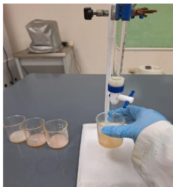
Figura 2. Determinación del índice de acidez del aceite
